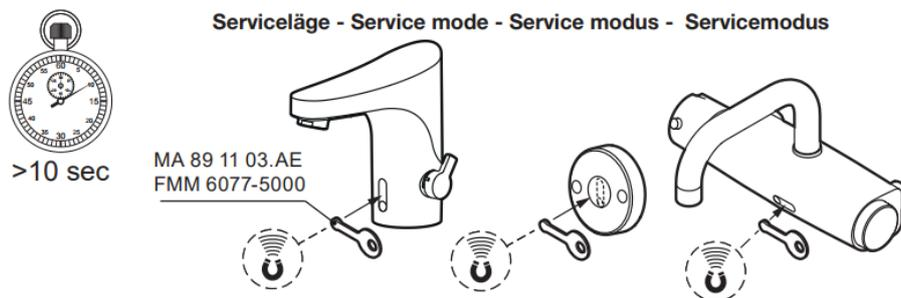
2. Wenn sich die Armatur im Servicemodus befindet, wird sie innerhalb von 1 Minute angezeigt (siehe Bilder)
